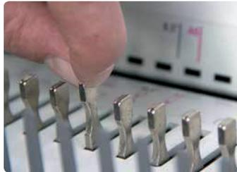
Die QSA-Technologie (Quick Size Adjustment) erlaubt das sekundenschnelle Ausschalten der Stanzstempel, wodurch Papierformate einfach und schnell gewechselt werden können.<sup>(1)</sup>
