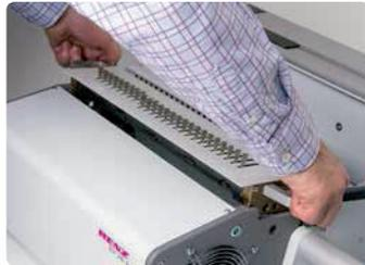
Simplex, vertikales Einhängesystem für schnellen und einfachen Werkzeugwechsel.
