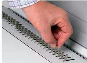
Die QSA-Technologie (Quick Size Adjustment) erlaubt das sekundenschnelle Ausschalten der Stanzstempel ohne Ausbau des Werkzeugs.
