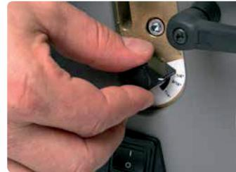
Der Randabstand kann mit Hilfe eines Drehknopfes zwischen 2 mm und 4,5 mm angepasst werden<sup>(1)</sup>. Somit kann tiefer in das Papier gestanzt werden.
