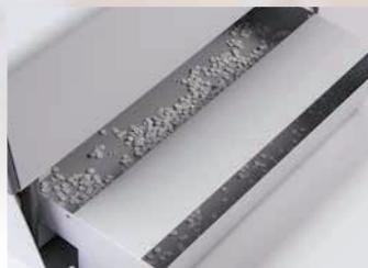
Große Abfallschublade kann zur Entleerung bequem an der Rückseite der Maschine entnommen werden.
