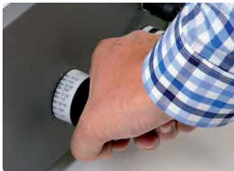
Schnelle und praktische Durchmesser-einstellung mittels Handrad für perfekte Bindung.
