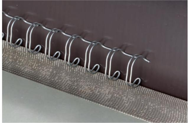
Die Magnetleiste fixiert den Drahtkamm und unterstützt so den Bindevorgang
