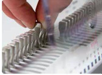
Die QSA-Technologie (Quick Size Adjustment) erlaubt das sekundenschnelle Ausschalten der Stanztempel, wodurch Papierformate einfach und schnell gewechselt werden können.<sup>(1)</sup>
