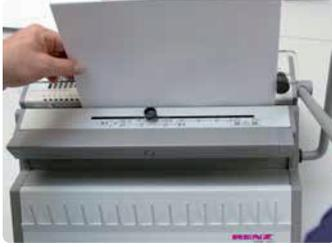
Vertikales Stanzen erhöht die Präzision beim Stanzvorgang.
