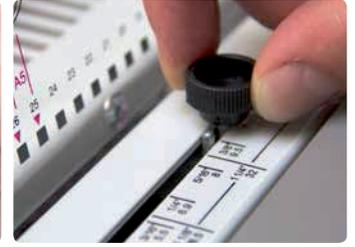
Bindet bis zu 135 Blatt. Die Durchmesserstellung garantiert ein schnelles und exaktes Schließen der Bindeelemente.
