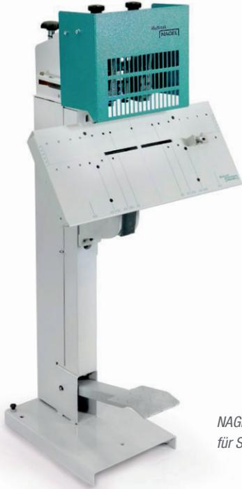
NAGEL-Multinak FS mit Fußbetrieb für Sattelheftung
