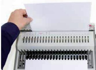
Vertikales Stanzen erhöht die Präzision beim Stanzvorgang.
