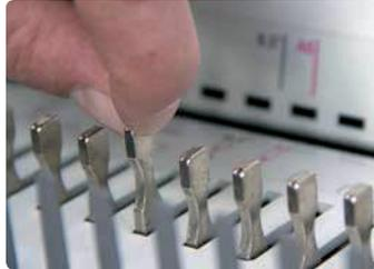
Die QSA-Technologie (Quick Size Adjustment) erlaubt das sekundenschnelle Ausschalten der Stanzstempel, wodurch Papierformate einfach und schnell gewechselt werden können.
