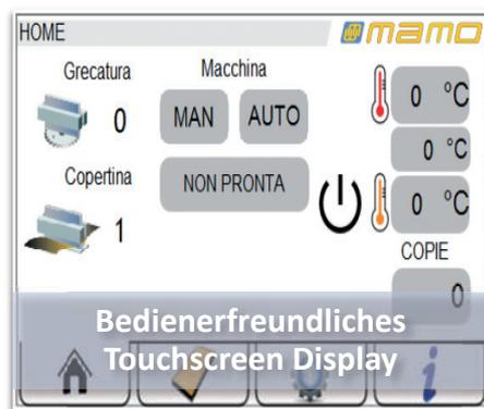
Fortschrittliche Steuerungstechnik mit aktueller Software erlaubt die Einstellung aller Parameter für jeden Produktionsschritt über ein bedienerfreundliches Touchscreen – Display. Der Bindevorgang kann in manuellem oder automatischem Modus erfolgen:
